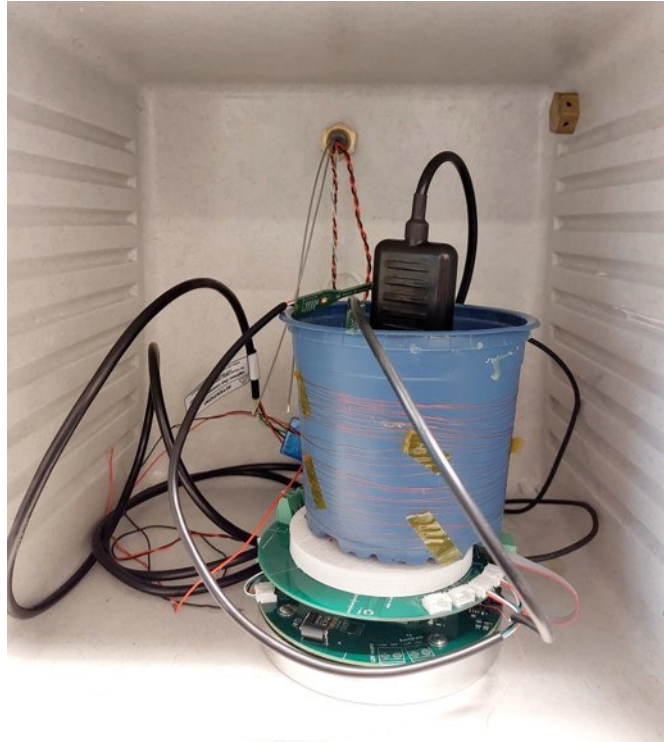
Abbildung 23: Experimentelle Kalibrierungsvorrichtung im Labor des KMUs Quantified B.V.
