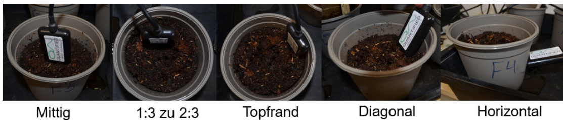
Abbildung 26: Labortests für die Ermittlung der besten Messqualität resultierend aus den Grundsätzen Precision, Accuracy & Repeatability. Die diagonale Position zeigte den besten Kompromiss aus Praktikabilität und Messqualität.
