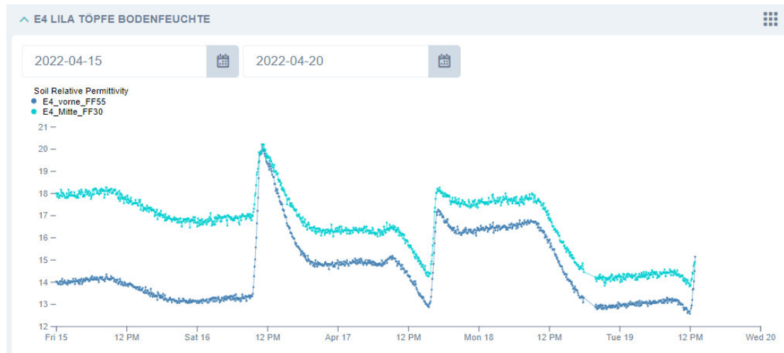
Abbildung 27: Es empfiehlt sich eine Initialisierungsphase einzuplanen, in der die Funktionalität des Sensorsystems überprüft werden kann. Hier sieht man die Annäherungen der Messwerte zweier Bodenfeuchte-Sensoren, die über durch die Sackung und Quellung des frisch getopften Substrats begründet werden kann.
