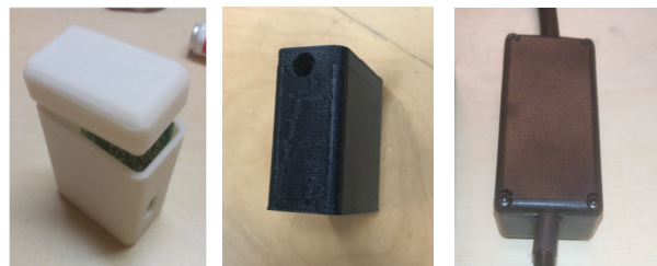
Abbildung 9: Evolution des Elektronikgehäuses
